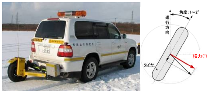
図-1 連続路面すべり抵抗値測定装置 (左：CFT全体、右：測定原理)
