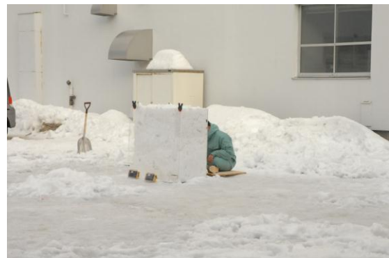
写真3 電磁探査機による試験状況
