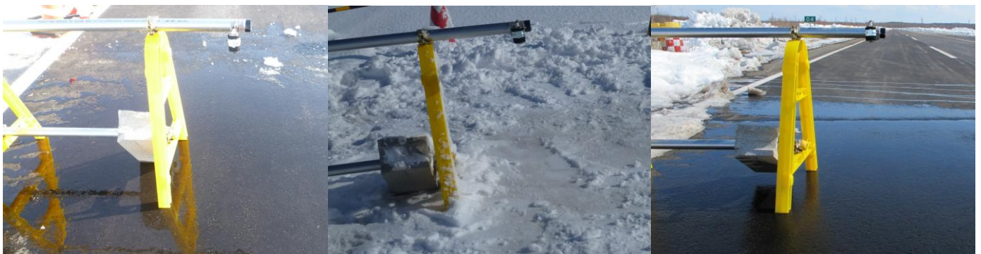
写真-2 模擬路面作製状況（左：氷膜路面、中：圧雪路面、右：湿潤路面）
