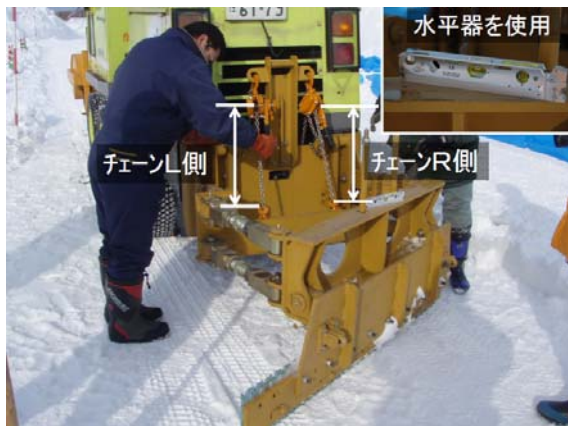
写真-9 チェーン長さの調整
