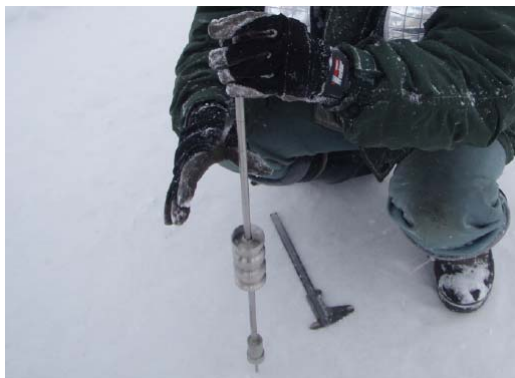
写真-4 木下式雪硬度計での計測
