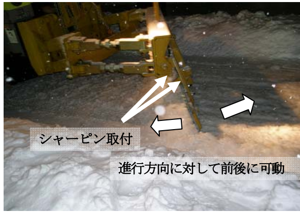
写真-8 シャーピンを外して排雪装置をフラップ状に可動させた状態
