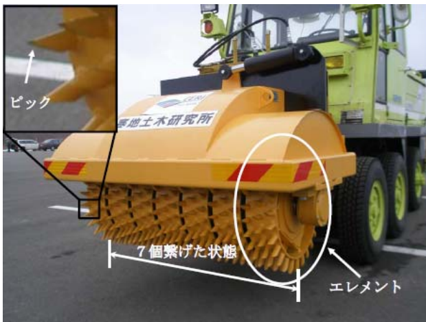
写真-2 氷板・圧雪路面処理装置
