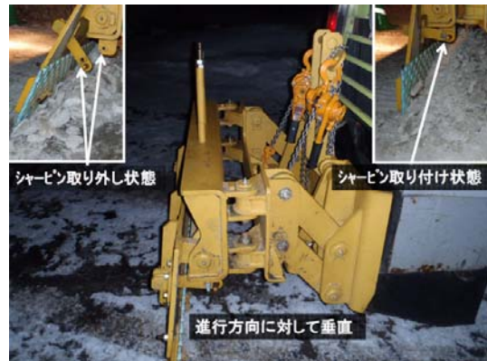
写真-10 シャーピン取付によるエッジ状態の違い
