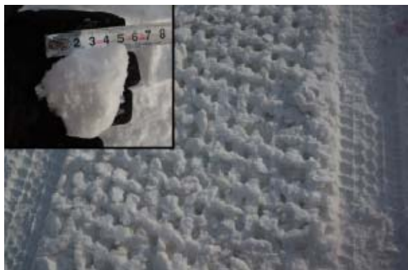
写真-6 処理装置施工後の路面状態及び破碎雪氷
