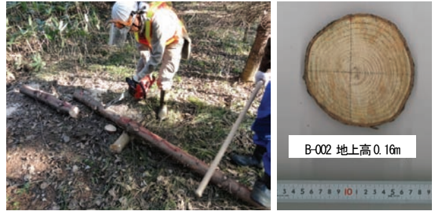
写真-1 試料木からの円盤採取状況
