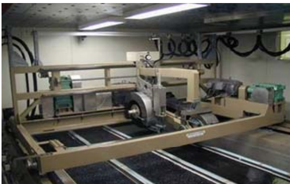
写真-1 室内凍結路面走行試験装置
