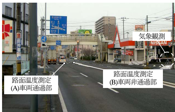
写真-1 車両通過部と非通過部の路面温度比較実験の概要
