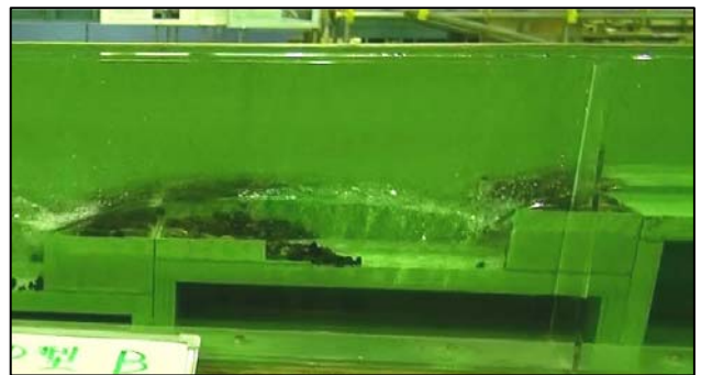
図-18 砂利堆積状況（Bタイプ）
