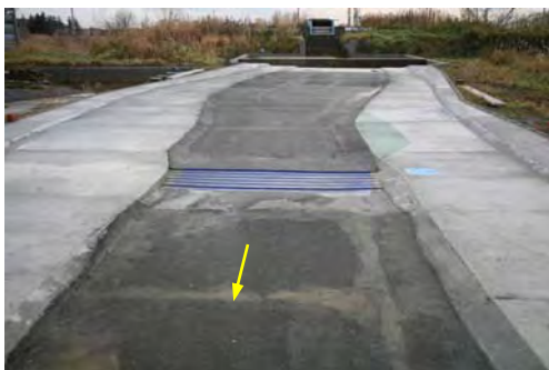
図5 永山床止工の模型の写真（上側が上流）
