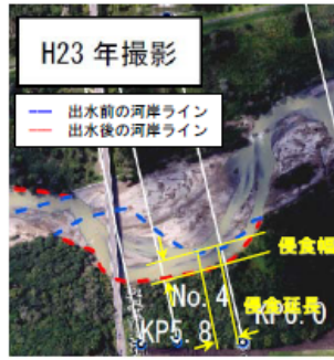
図-2 侵食幅の計測方法
