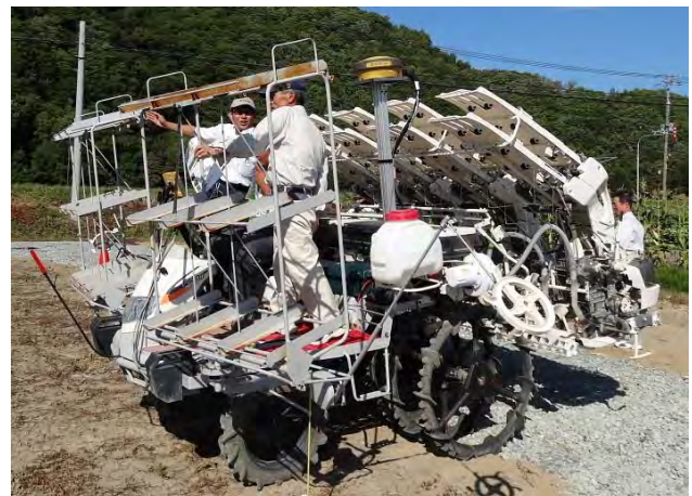
図-9 GNSS 受信機を搭載した田植機
