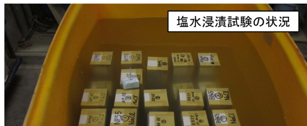
写真-2 凍結融解試験および塩水浸漬試験の状況
