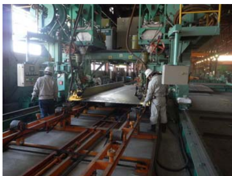
写真-11 主桁の製作
