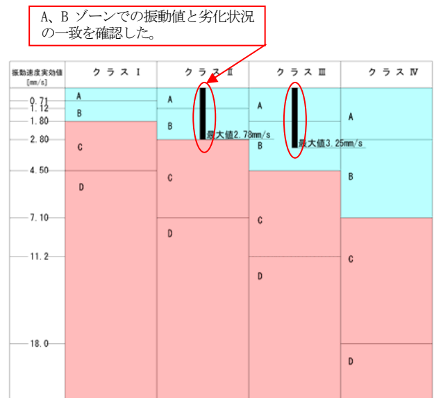
※上図は図-4の621点の振動速度実効値をISO判定基準にプロットしたものである。
