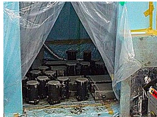
写真-1 蒸気養生状況
