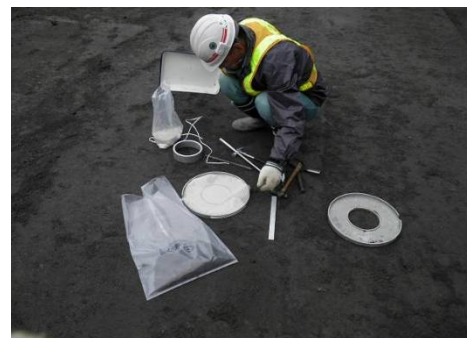
写真-3 砂置換法 (現場密度試験)
