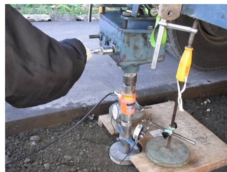
写真-4 現場 CBR 試験
